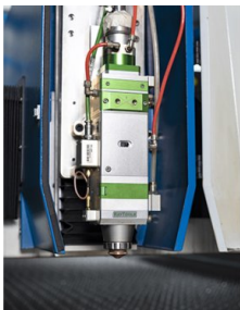
Tête de coupe de haute qualité avec autofocus de la société RayTools
