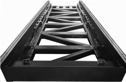
Рама станка тщательно сварена и термически обработана
