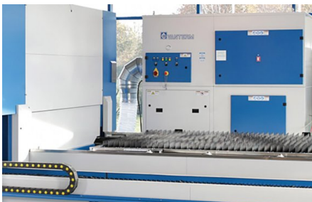
Stroj je standardně vybaven odlučovačem prachu a filtrační jednotkou s účinností 99,997 %
