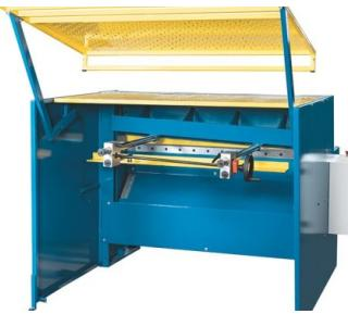
*La cubierta del espacio de trabajo con montaje giratorio asegura la seguridad del operador*
