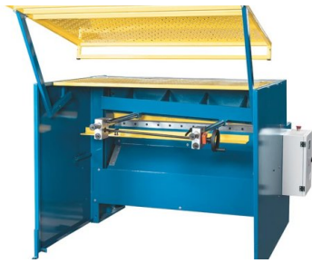
Copertura mobile sull'area di lavoro per garantire la sicurezza dell'operatore
