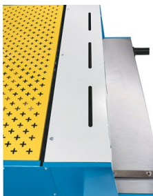
Copertura mobile sull'area di lavoro per garantire la sicurezza dell'operatore
