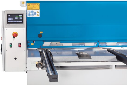
Seitenanschlag mit Skalierung und manuell einstellbarer Schnittpaltverstellung
