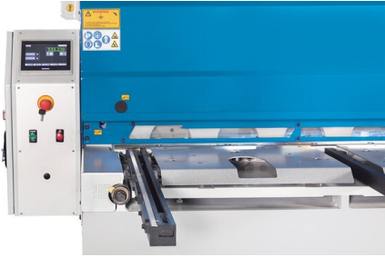
Tope lateral con escala y ajuste manual del corte
