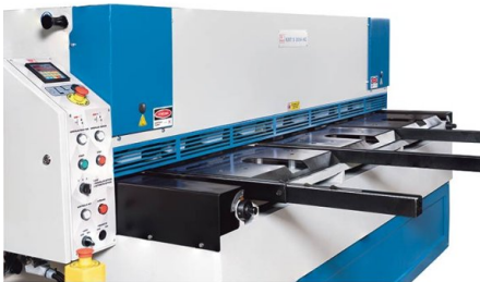
Die im Tisch eingelassenen Materialauflagekugeln erleichtern das Werkstückhandling
