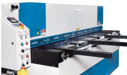
Les billes de support du matériau encastrées dans la table facilitent la manutention des pièces
