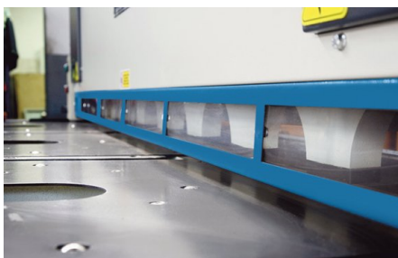
Wpuszczone w stół kulki do przyłożenia materiału ułatwiają obróbkę detali
