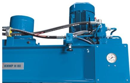
*Le groupe hydraulique compact est intégré dans le châssis de la machine et offre une force maximale dans un espace restreint*
