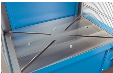
Диагонально расположенные пазы облегчают центрированную фиксацию инструментов
