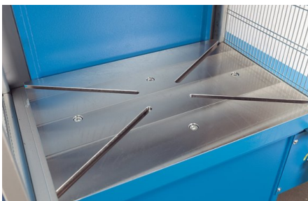
Ranuras alineadas en diagonal para facilitar la sujeción de la herramienta centrada
