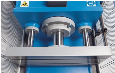
Două ghidaje rotunde adiționale garantează paralelismul poansonului pe parcursul cursei
