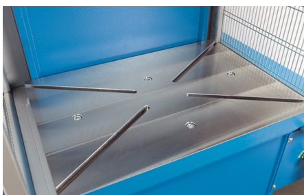
Diagonálně orientované drážky usnadňují vycentrované upnutí nástrojů
