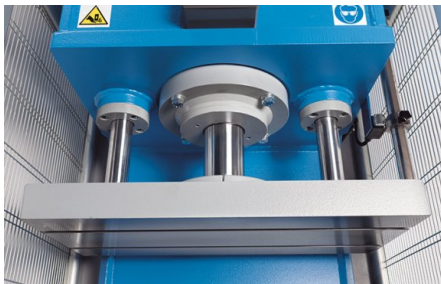
Due guide cilindriche garantiscono il parallelismo della piastra dello slittone durante la corsa
