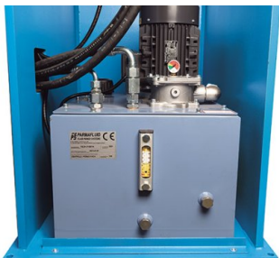
Sistema hidráulico que ahorra espacio y está situado en el interior del bastidor
