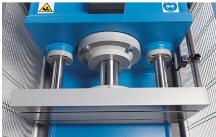
Dos guías circulares garantizan el máximo paralelismo de la placa del ariete durante el movimiento de la carrera
