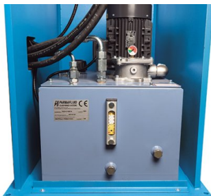
Sistemul hidraulic este compact, dar încorporat în cadru astfel încât să fie ușor accesibil
