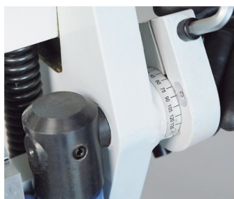
Угловой упор обеспечивает точный повтор настроек для каждой заготовки
