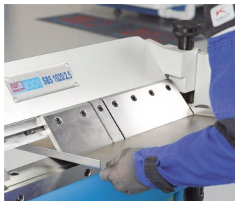
Сегментированная верхняя полуформа позволяет обрабатывать коробчатые профили с различной длиной сторон
