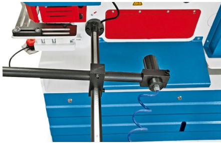
Riscontro posteriore con arresto automatico del taglio
