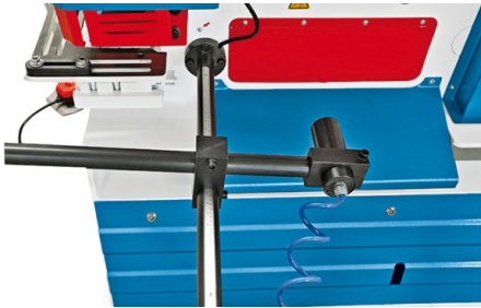
Задний упор с автоматической активацией резки
