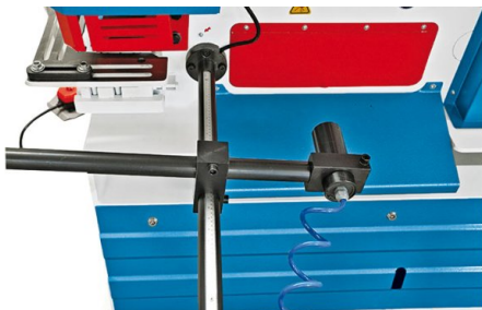
Butée arrière à déclenchement de coupe automatique
