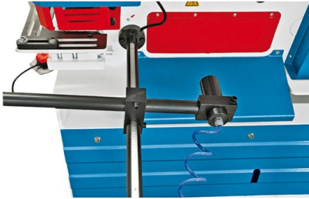
Calibre trasero con activación automática de corte
