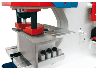
Lochstanzstation mit großem Auflagetisch
