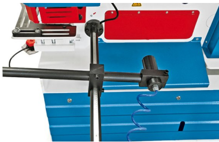
Ogranicznik tylny z automatycznym rozpoczęciem skrawania
