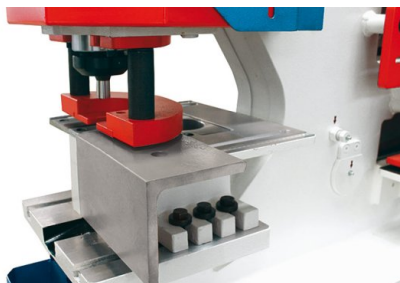
Stazione di punzonatura con ampia tavola di piazzamento
