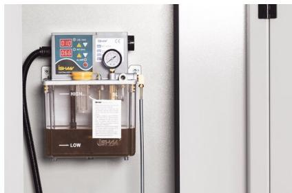
*Une lubrification centrale alimente tous les points de lubrification d'une machine de manière automatique et continue en assurant la quantité de lubrifiant nécessaire. Un réservoir central stocke le lubrifiant, qui est ensuite distribué aux différents points de lubrification par un système de conduites. Le dosage est régulé électroniquement*
