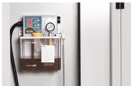
*Un sistema automático de lubricación central abastece continuamente todos los puntos de lubricación y simplifica el mantenimiento. El lubricante se almacena en un depósito central y se distribuye a través de conductos a todos los puntos de lubricación. El lubricante se dosifica mediante control electrónico*
