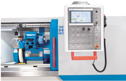
Die Programmierung der einzelnen Schleifzyklen erfolgt über einen Touchscreen
