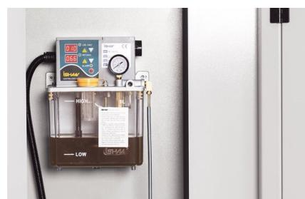
Un sistema di lubrificazione centralizzata fornisce automaticamente e continuamente il lubrificante necessario a tutti i punti di lubrificazione di una macchina. Un contenitore centrale immagazzina il lubrificante, che viene distribuito ai singoli punti di lubrificazione tramite un sistema di condutture
