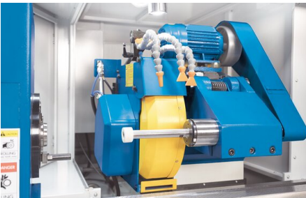
Zařízení pro vnitřní broušení se v případě potřeby otočí do pracovní oblasti
