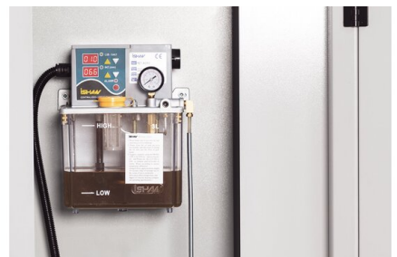
Centrální mazání automaticky a průběžně zásobuje všechna mazací místa stroje potřebným mazivem. V centrální nádobě je uloženo mazivo, které je prostřednictvím systému vedení rozváděno k jednotlivým mazacím místům. Dávkování je řízeno elektronicky
