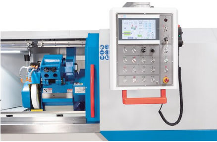
Programování jednotlivých brusných cyklů se provádí pomocí dotykové obrazovky
