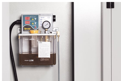
Eine Zentralschmierung versorgt alle Schmierstellen einer Maschine automatisch und kontinuierlich mit dem erforderlichen Schmierstoff. Ein zentraler Behälter speichert den Schmierstoff, der über ein Leitungssystem zu den einzelnen Schmierstellen verteilt wird. Die Dosierung erfolgt elektronisch geregelt
