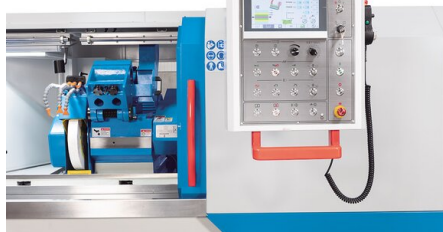
Programowanie poszczególnych cykli szlifowania odbywa się na ekranie dotykowym
