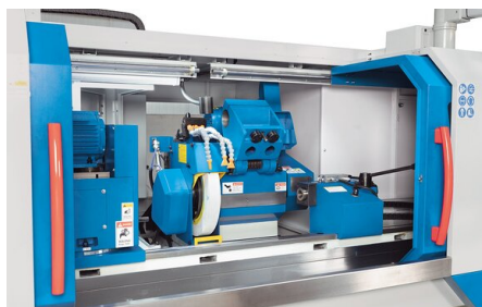
Całkowicie osłonięta przestrzeń robocza jest bardzo dobrze dostępna przez duże drzwi
