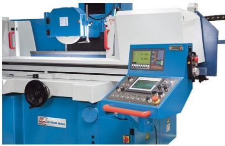
*Si se ajusta en el modo Auto, los parámetros de desbaste y acabado definidos por el usuario, el número de chispas y el retorno a cero se procesan automáticamente*
