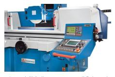
In modaliltà di sgrossatura e di finitura, i valori relativi al numero di corse di spegnimento ed al ritorno al punto di partenza impostati dall'operatore vengono elaborati automaticamente mediante un volantino elettronico.
