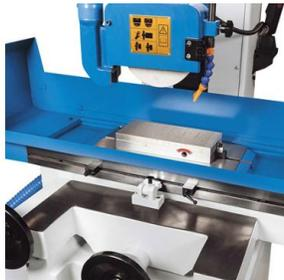
*Piastra di bloccaggio a magneti permanenti con micro-passo polare - ideale per lavorazioni di precisione*
