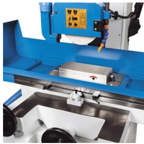
Stół magnetyczny doskonale przystosowany do szlifowania precyzyjnego
