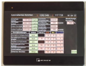
Nella funzionalità di lavorazione costante è possibile inserire la modalità di rinvivatura mola con compensazione automatica della dimensione e regolazione della velocità per eseguire rettifiche a velocità costante
