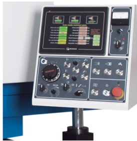
La programmation des cycles de rectification s'effectue par écran tactile
