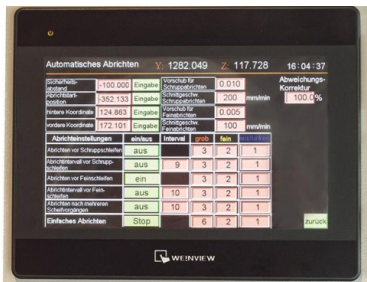
El modo de reavivación para las muelas de rectificado con compensación automática de velocidad (RPM) y dimensión asegura una tasa de rectificado constante y se puede ingresar mientras está en modo automático
