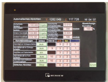
Do automatického provozu stroje lze zavést režim srovnávání pomocí brusného kotouče s automatickou kompenzací rozměru a přizpůsobením rychlosti pro konstantní rychlost broušení
