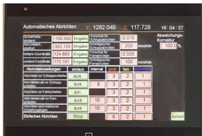
Do automatického provozu stroje lze zavést režim srovnávání pomocí brusného kotouče s automatickou kompenzací rozměru a přizpůsobením rychlosti pro konstantní rychlost broušení
