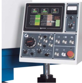
La programmation des cycles de rectification s'effectue par écran tactile
