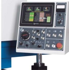
Pantalla táctil para una fácil programación de los ciclos de rectificado
