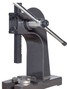
Presse à mandrins rotatifs pour le brochage, le poinçonnage et le pressage
