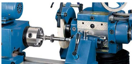
Круглое внешнее шлифование длиной до 400 мм
