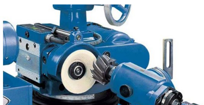
Sistem stabil de fixare piese cu unghi reglabil
