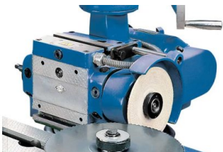
Affûtage d'une lame de scie
