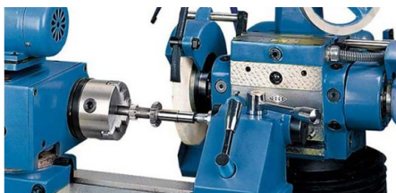
Zewnętrzne szlifowanie cylindryczne do 400 mm długości
